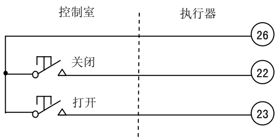
图 8-1 点动式打开/关闭控制，执行器可以停在途中任意位置
